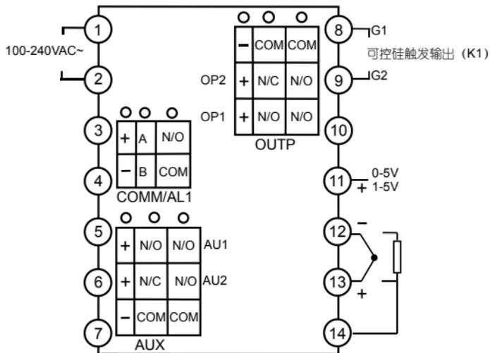
注：线性电压量程在500mV以下的由13+、12-端输入端输入，0~5V及1~5V的信号由11、12端输入。4~20mA线性电流输入可用250欧电阻变为1~5V电压信号，然后从11+、12-端输入。COMM位置安装S或S4通讯接口模块时用于通讯，安装继电器/无触点开关/SSR电压输出模块时用于AL1报警输出。
