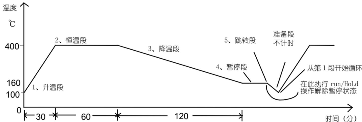
采用温度~时间编程方法的优点是升温、降温的斜率设置的范围非常宽。升温及恒温段具有统一的设置格式，方便学习。设置曲线更灵活，可以连续设置升温段(如用不同斜率的升温段近似实现函数升温)，或连续的恒温段。
