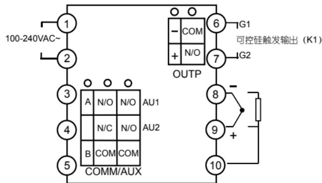
注1：D2面板尺寸仪表线不支持0~5V及1~5V线性电压输入，如有需要应外接精密电阻分压后将信号转换为0-500mV或100-500mV输入、4~20mA线性电流输入用25欧电阻变为100~500mV，然后从9、8端输入。
