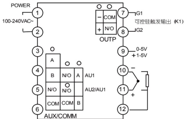
注1： 线性电压量程在500mV以下的由10-、11+输入，0~5V及1~5V的信号由9+、10-端输入。
