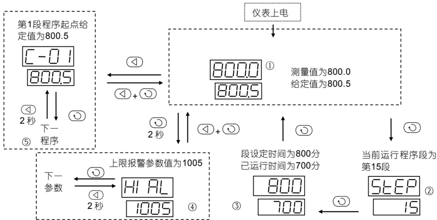
仪表上电后，将进入显示状态①，此时仪表上显示窗口显示测量值（PV），下显示窗口显示给定值（SV）。此为仪表的基本状态，在基本状态下，SV窗口能用交替显示的字符来表示系统某些状态，如下：
